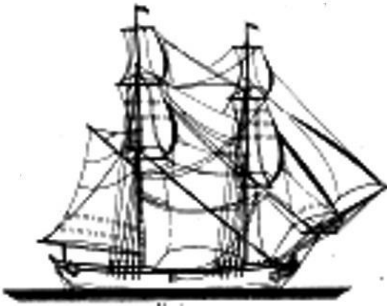
Figur 26. Teckning visande riggingen på en krejare.
